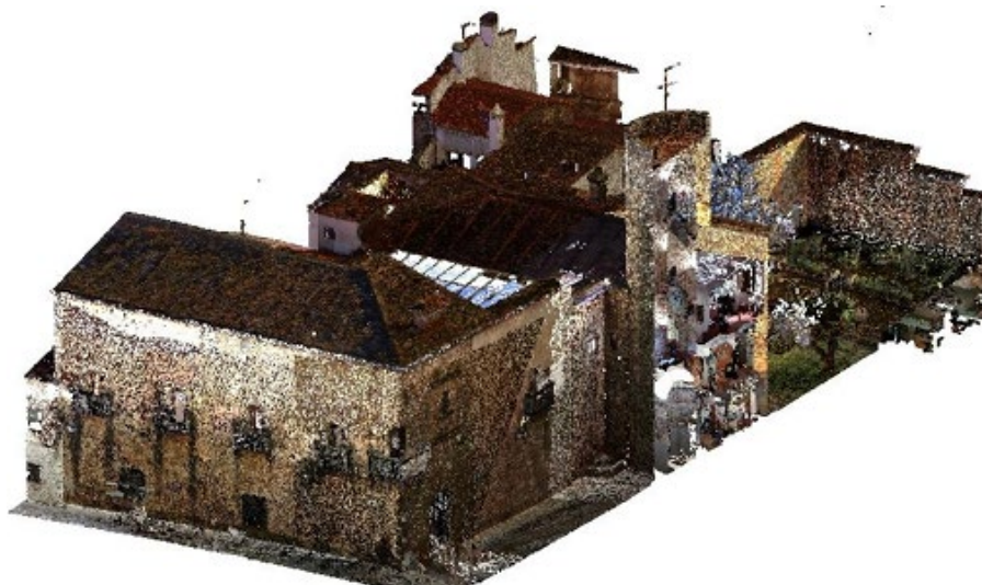
Figura 5. Nube de puntos de muestra al exterior del edificio de arquitectura tradicional Palacio Carvajal ubicado en Cáceres. Fuente: Anexo 1 levantamiento aplicando láser escáner 3d para generación de nube de puntos y modelado BIM
