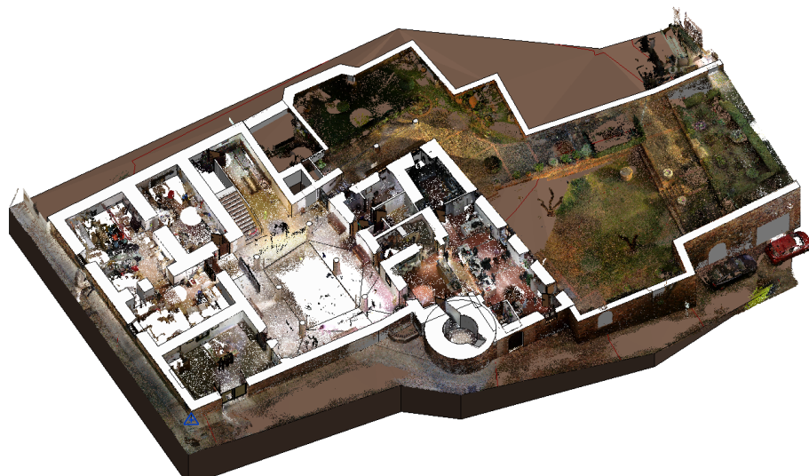
Figura 14. Superposición de nube de puntos con modelo tridimensional en Revit para análisis geométrico
